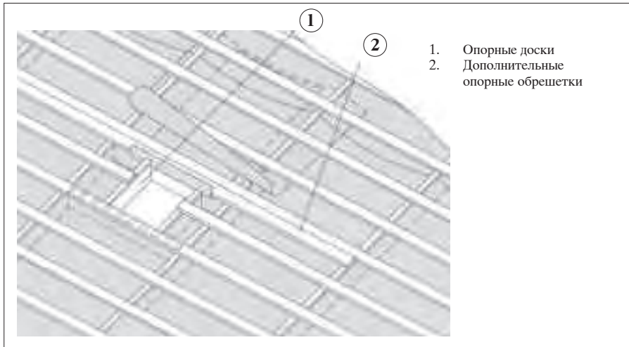
рис. 11 Опорные доски сквозного вывода
