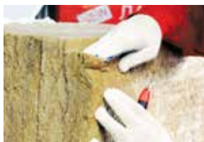
Пружинящий край поджимается и разжимается
