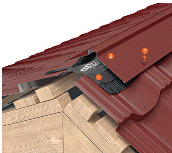
1. Аэроэлемент конька 2. Планка конька 3. Саморез
