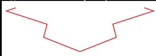
При длине ската превышающего 8 м развернутая ширина желоба ендовы должна иметь общую ширину около 825 мм, при этом необходимо увеличить на 100 мм ширину каждого из нижних сливных каналов.
