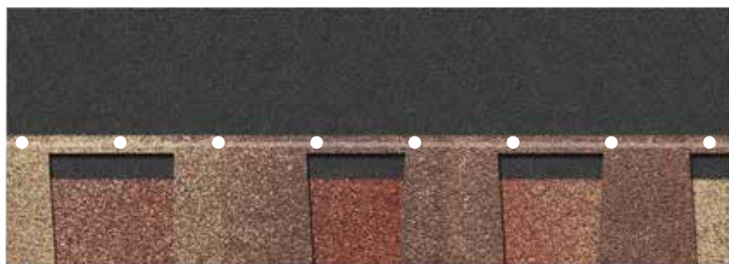
Рис. 1. Схема расположения гвоздей при монтаже Döcke PIE DRAGON.
