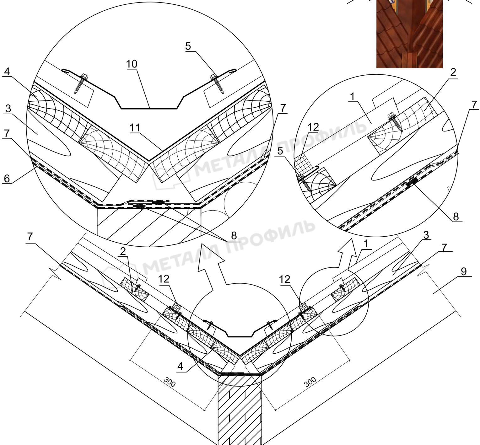
1. Кровельное покрытие (например: металлочерепица или профнастил)
