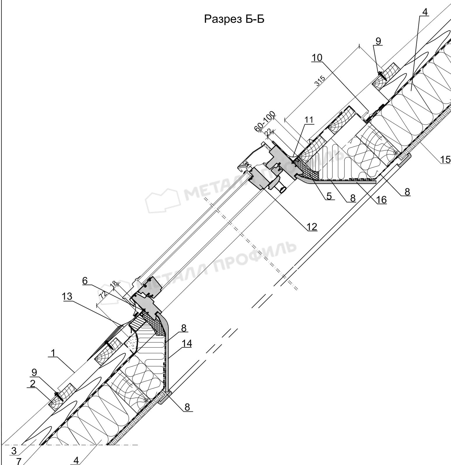
1. Кровельное покрытие (например, металлочерепица МП Ламонтерра®)
