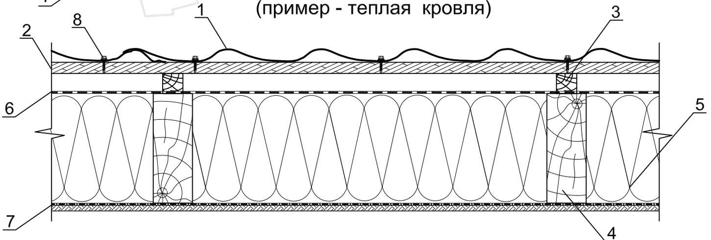
1. Кровельное покрытие (например: металлочерепица или профнастил)
