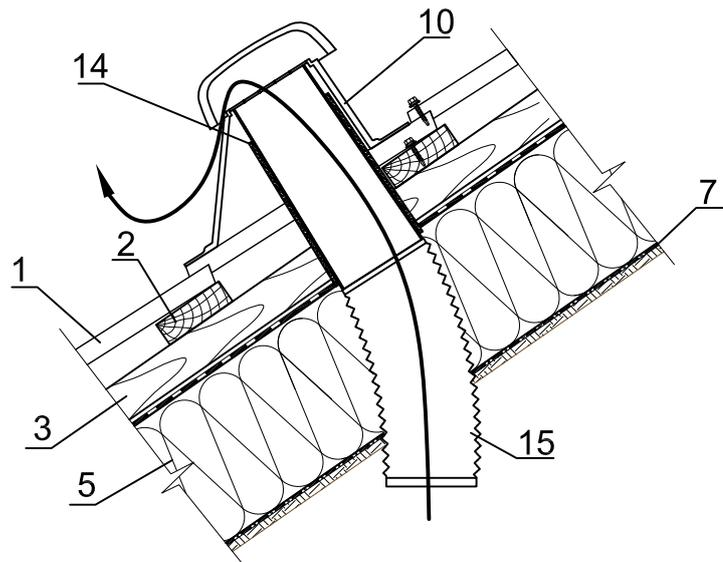
1. Кровельное покрытие (например: металлочерепица или профнастил)
