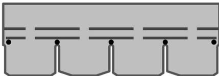
Черепица прибивается так же, как при уклоне крыши меньше 45°, дополнительно вбиваются два гвоздя в верхние углы гонта.
