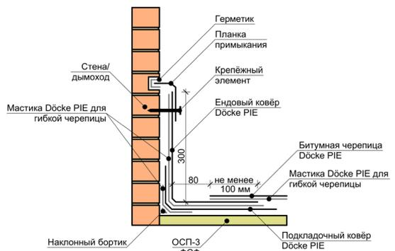
Рис. 25 Примыкание ската крыши к выступающим над ней конструкциям под углом не более 90° включительно.
