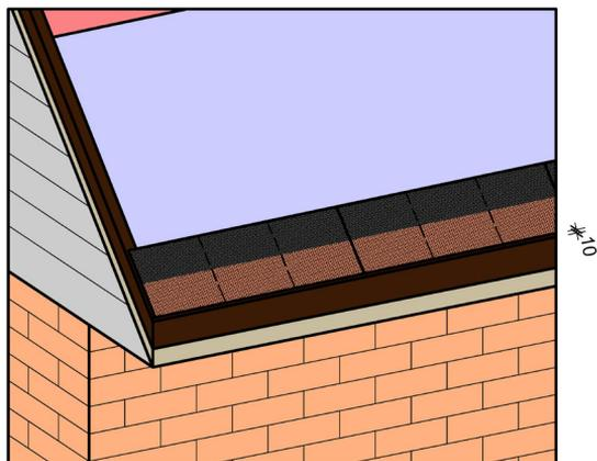
Рис. 11 Схема укладки карнизной черепицы на карниз.
