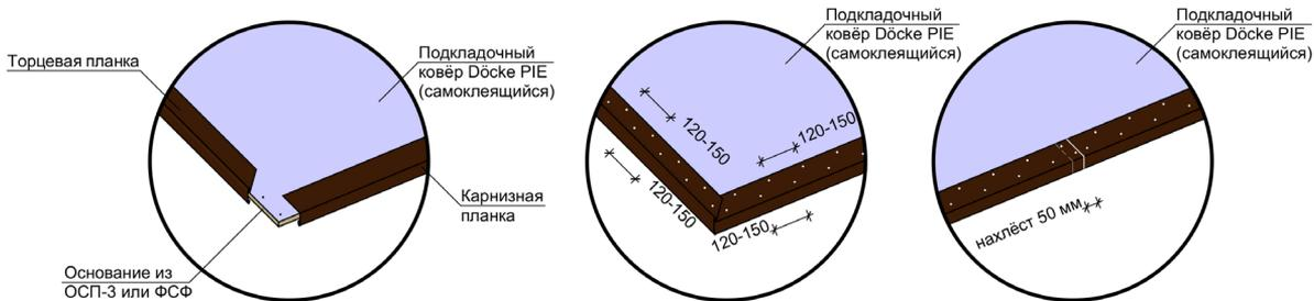
Рис. 8 Крепление металлических карнизных и торцевых планок.
