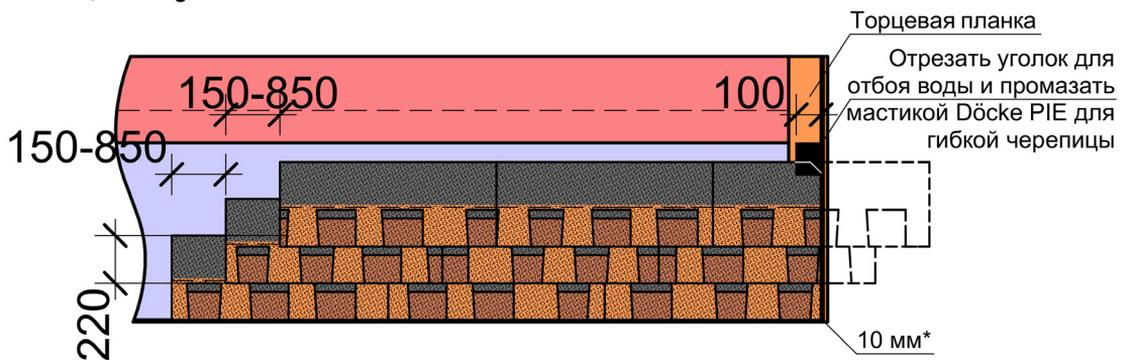
\* - зазор 10 мм между битумной черепицей и ребром торцевой планки.
