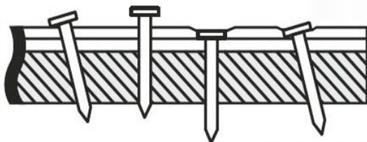
Рис. 3 Пример неправильной забивки гвоздей при монтаже продукции.
