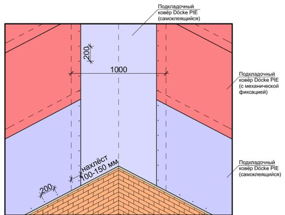
Рис. 7 Схема монтажа подкладочного ковra в ендове и на смежных скатах.
