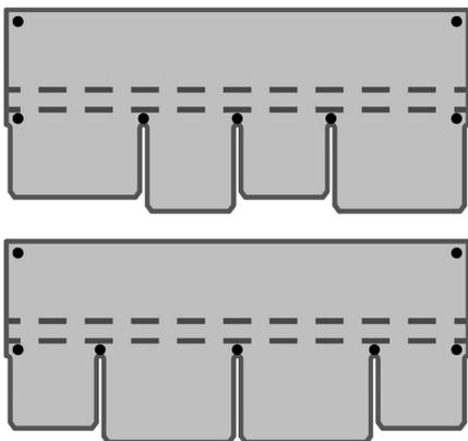
Черепица прибивается пятью гвоздями посередине нижней границы отрезка нижней клеевой полосы, а также вбиваются два гвоздя в верхние углы гонта.
