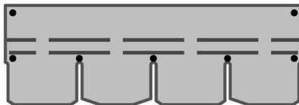
Черепица прибивается пятью гвоздями посередине нижней границы отрезка нижней клеевой полосы, а также вбиваются два гвоздя в верхние углы гонта.
