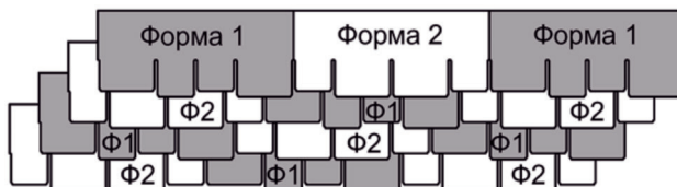
Рис. 15 Схема чередования гонтов гибкой битумной черепицы Döcke PIE коллекции «Саппоро».
