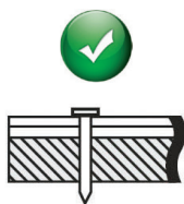
Рис. 2 Пример правильной забивки гвоздей при монтаже продукции.
