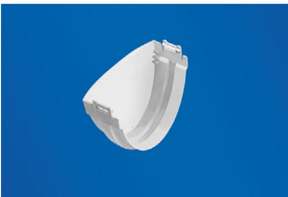
Заклушка желоба применяется для герметизации конечных участков водосточной системы. Заклушка в отличие от желоба имеет симметричную форму, что позволяет использовать её на любом торце. По краям заклушки располагаются крепежные защелки, которые позволяют герметично зафиксировать заклушку на конечном участке водосточной системы, с помощью использования специальных клипс (см.ниже).
