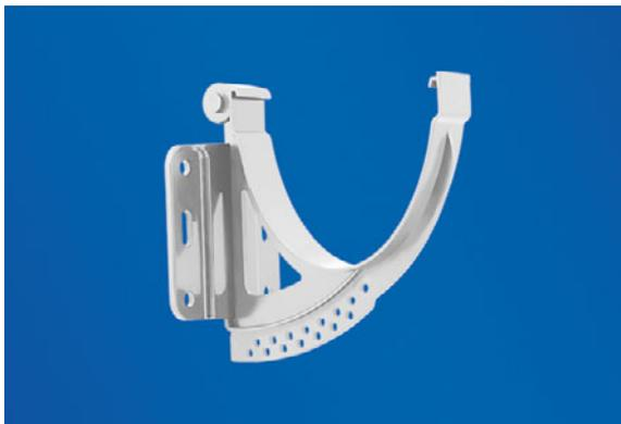
Кронштейн применяется для крепления желобов к вертикальной лобовой доске. Кронштейны необходимо устанавливать на расстоянии 60 см друг от друга. Кронштейн можно использовать как самостоятельный элемент крепления, так и вместе с поворотным элементом кронштейна (см. ниже.)
