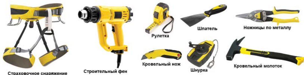
Рис. 1 Перечень инструментов кровельщика.
