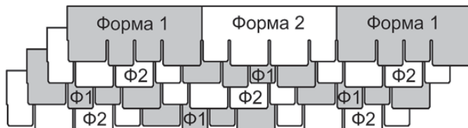
Рис. 17 Схема чередования гонтов гибкой битумной черепицы Döcke PIE коллекции Саппоро.
