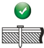
Рис. 2 Пример правильной забивки гвоздей при монтаже продукции.
