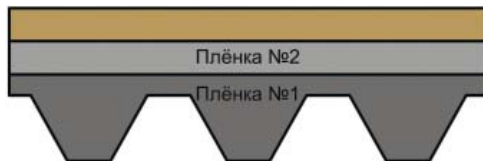
Рис. 15 Тыльная сторона гонта гибкой битумной черепицы Döcke PIE.
