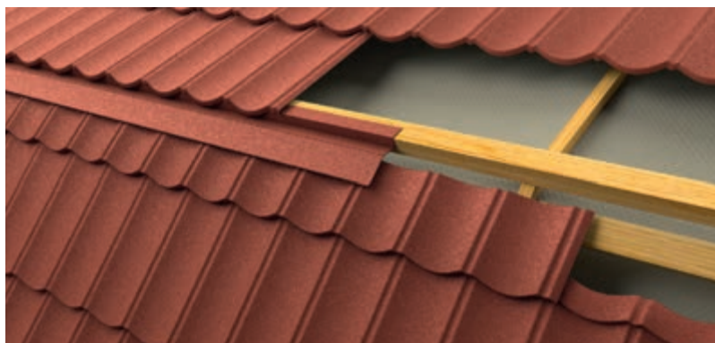
Рис. 34 Монтаж черепицы на внешнем переломе ската
