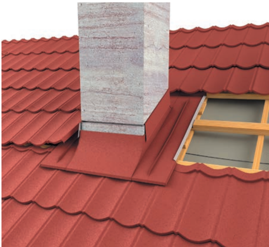
РИС. 32. 1 Примыкание к дымоходу с помощью оклада
